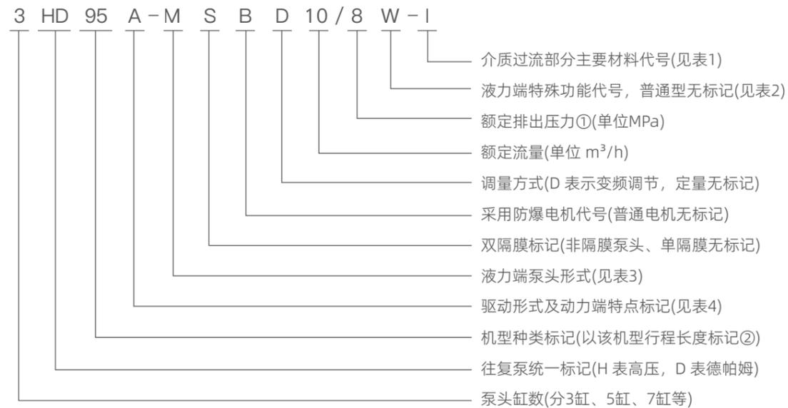
① 最高精确至0.1, 仅做标记用, 以泵数据表中实际参数为准 ② 行程长度精确至个位, 仅做机型标记用
